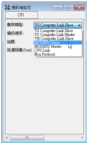
VS-PLC的应用类型设定为 MODBUS Slave
